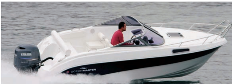
OCEANMASTER 601 Cabin: Länge 6.05 m, Breite 2.55 m, 920 kg, Tiefgang 0.32 m, Höhe 1.85 m, maximale Motorleistung 150 PS, 6 Personen, CE - Kategorie C
