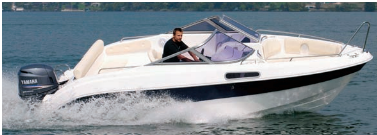
OCEANMASTER 601 Bowrider: Länge 6.05 m, Breite 2.55 m, 980 kg, Tiefgang 0.32 m, Höhe 1.50 m, maximale Motorleistung 150 PS, 6 Personen, CE - Kategorie C
