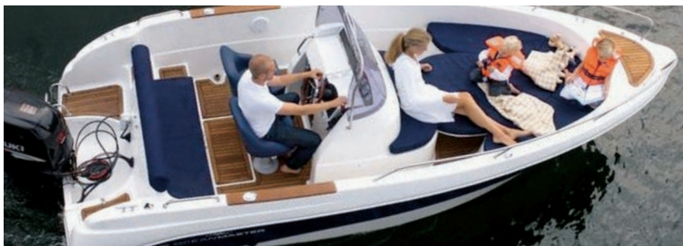
OCEANMASTER 605 Sun: Länge 6.05 m, Breite 2.54 m, 820 kg, Tiefgang 0.28 m, Höhe 1.50 m, maximale Motorleistung 150 PS, 8 Personen, CE - Kategorie C
