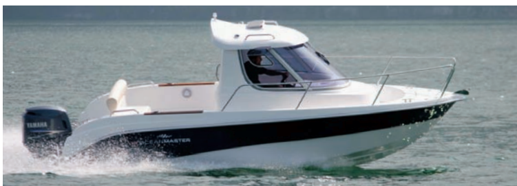
OCEANMASTER 625 Fish: Länge 6.05 m, Breite 2.54 m, 920 kg, Tiefgang 0.30 m, Höhe 2.50 m, maximale Motorleistung 150 PS, 6 Personen, CE - Kategorie C
