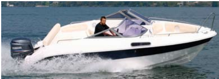
OCEANMASTER 601 Bowrider: longueur 6.05 m, largeur 2.55 m, 980 kg, tirant d'eau 0.32 m, hauteur 1.50 m, puissance max. du moteur 150 cv, 6 personnes, catégorie EC C
