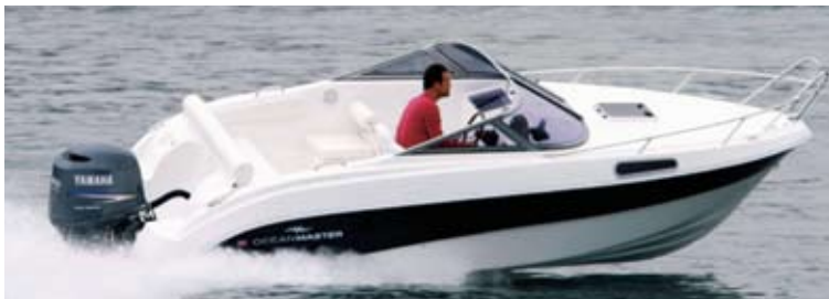
OCEANMASTER 601 Cabin: longueur 6.05 m, largeur 2.55 m, 920 kg, tirant d'eau 0.32 m, hauteur 1.85 m, puissance max. du moteur 150 cv, 6 personnes, catégorie EC C
